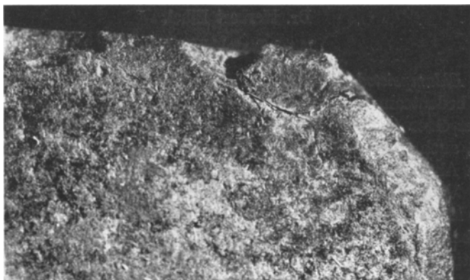
Abb. 1. Aufschlagfläche des Hammers mit Splitter. Vergr. ca. 15 : 1.
